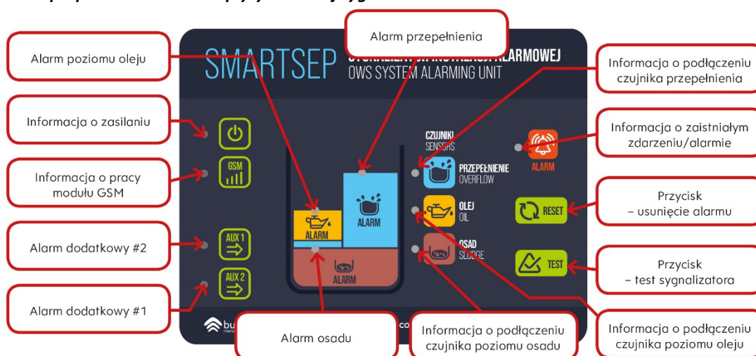
Rysunek 1. Opis panelu sterowania płyty czołowej sygnalizatora
